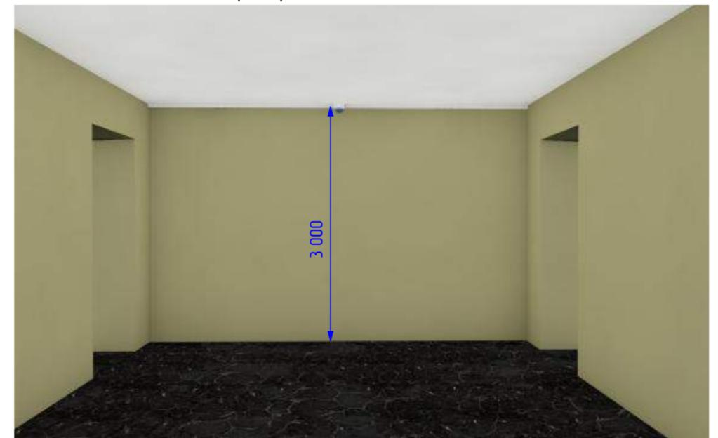
визуализация размещения видеокамеры № 12 в помещении № 32
