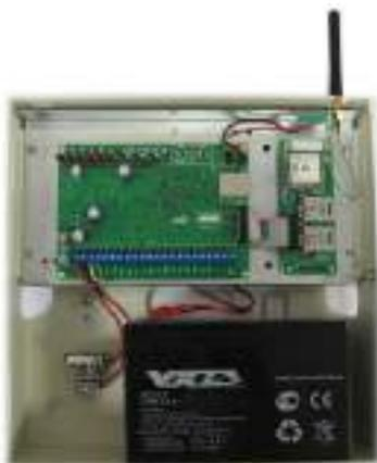
Прибор нового поколения, оснащенный 2-х симочным GSM модулем и выходом Ethernet. Подходит для охраны как квартир, так и особо важных объектов. Может быть использован в одном из двух режимов:
