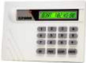
«С2000» предназначен для информационного объединения приборов ИСО «Орион» с целью организации единого центра управления и сбора системных сообщений, объединения шлейфов сигнализации в разделы, создания перекрестных связей между разделами и выходами разных приборов, расширения возможностей отображения информации.
