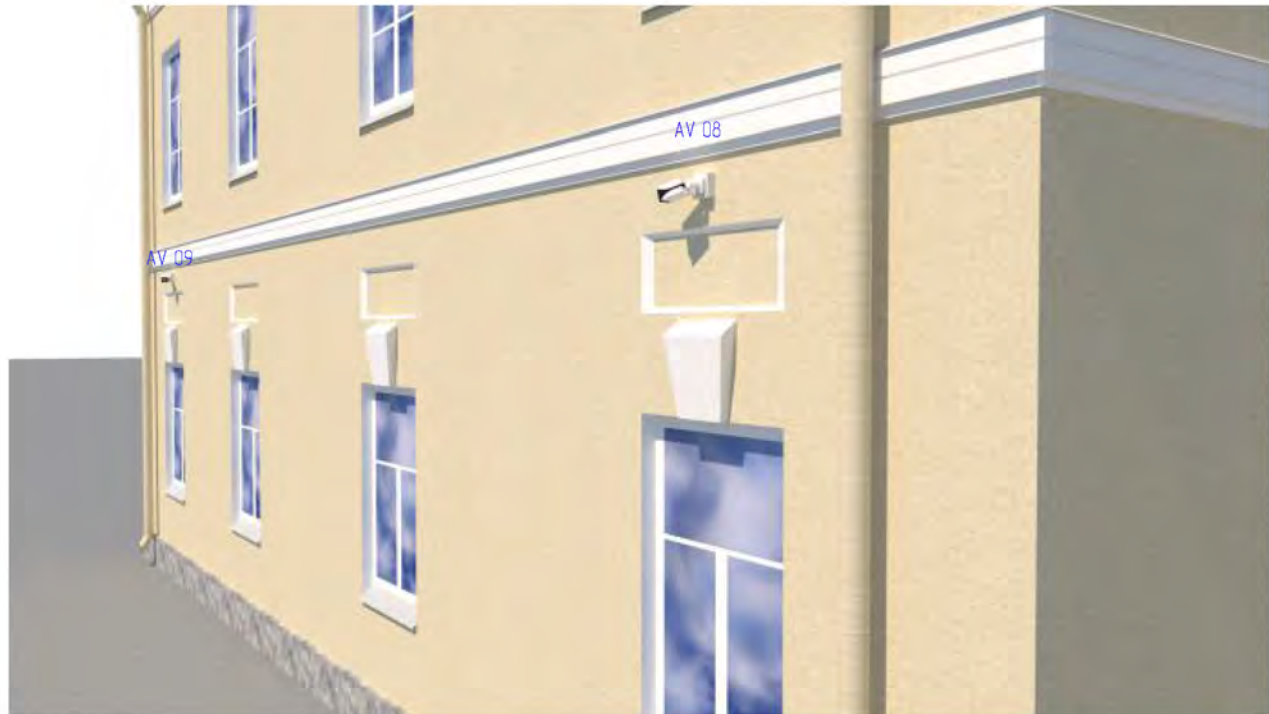
Размещение видеокамер в осях Г-1, И-1
