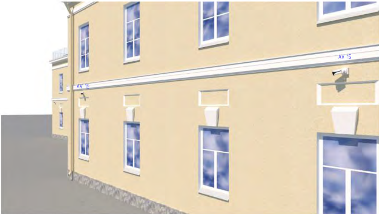
Размещение видеокамер в осях Г-10, И-10
