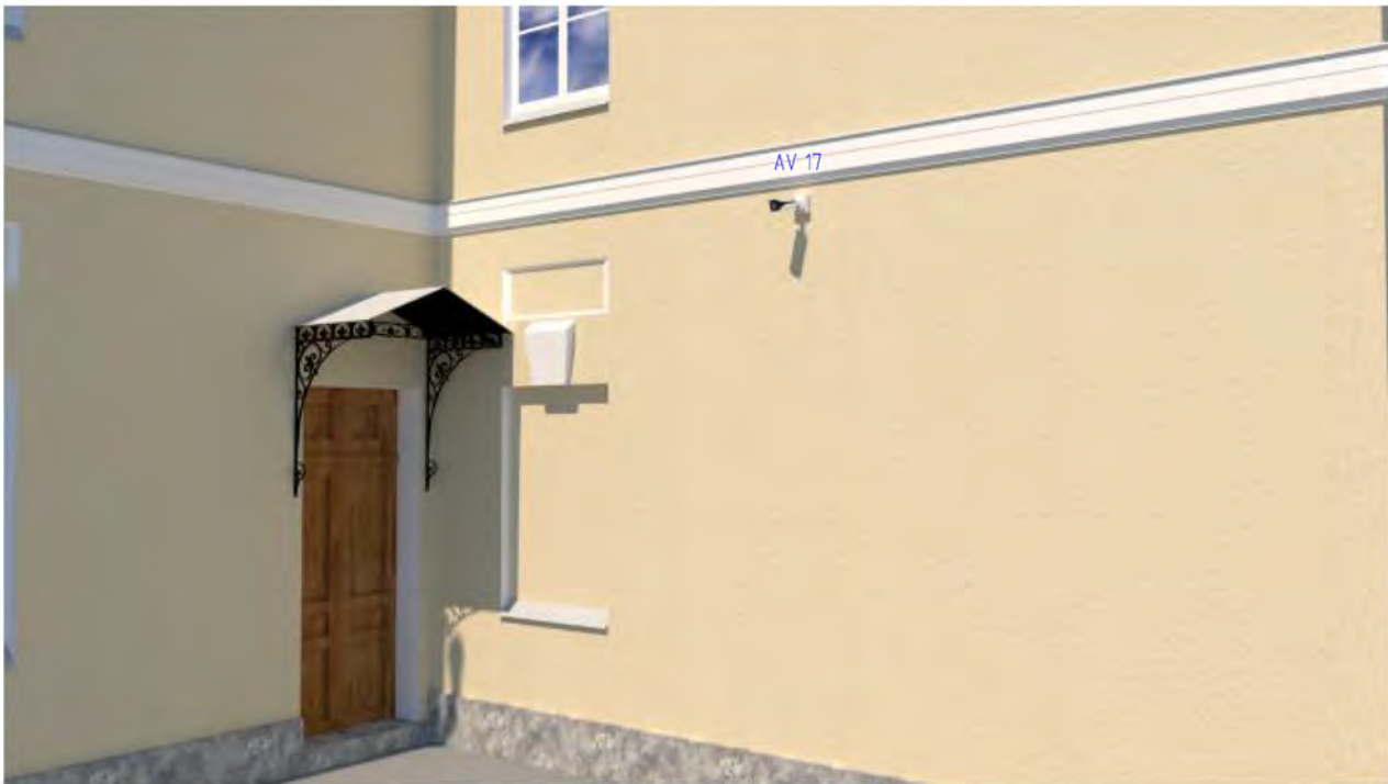
Размещение видеокамер в осях Г-9, Г-10
