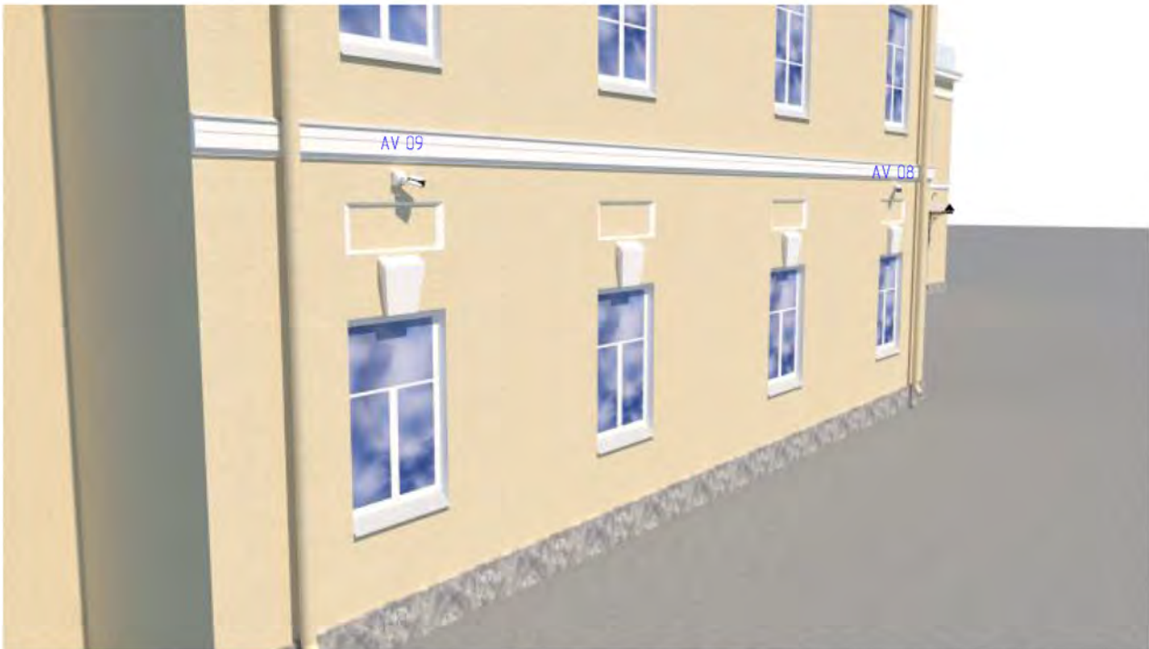
Размещение видеокамер в осях Г-1, И-1
