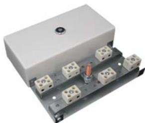
Монтажная коробка состоит из стального оцинкованного корпуса, верхняя часть которого снабжена декоративной пластиковой крышкой. В боковых стенках крышки имеются специальные легкоудаляемые профили для ввода кабеля, металлорукава или кабель-канала.
